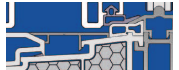
Spezielle Schwellenabdeckung für den Innenbereich
