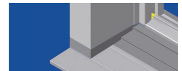
Durch den besonders flachen BSZ-Verbinder mit beidseitigen Dichtplatten wird eine äußerst effiziente und dichte Verbindung zur Bodenschwelle erzielt
